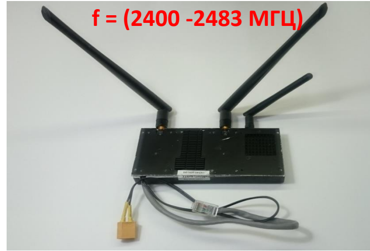
2 типа приемо-передающих блоков БПЛА
