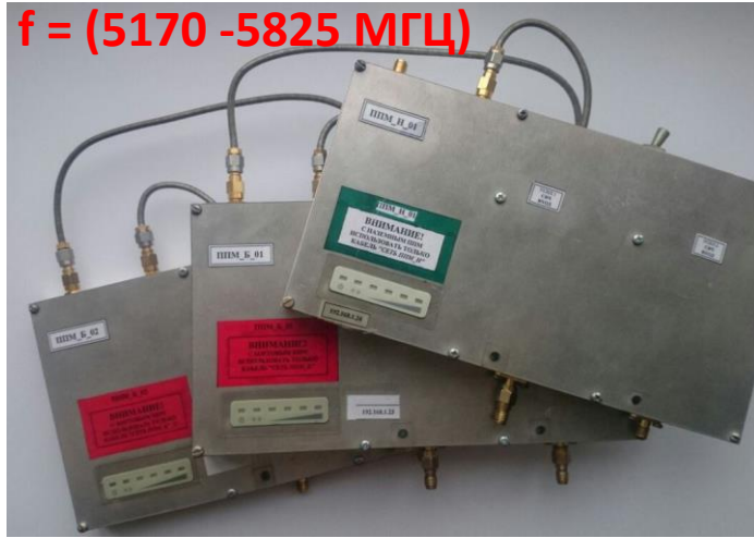
2 типа приемо-передающих блоков БПЛА
